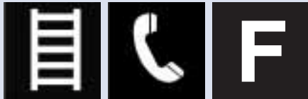
Notleiter Brandmelder Material zur Brandbekämpfung
